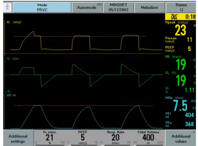
Şekil 1. PRVC modunda ayarlanabilen parametrelerin görüntüsü
